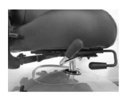
Après l'enclenchement audible, le levier du siège (rouge) doit être horizontal. S'il est encore tiré, le siège n'est pas encore verrouillé.
