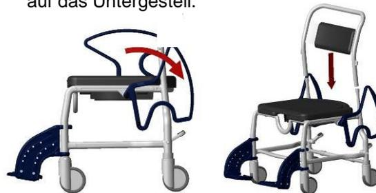
3. Schwenken Sie die Armlehnen wieder so weit nach vorne, dass diese in der Nut an der Rückenlehne, als auch mit dem Rastbolzen in das Untergestell einrasten (**siehe auch 10.3**).
